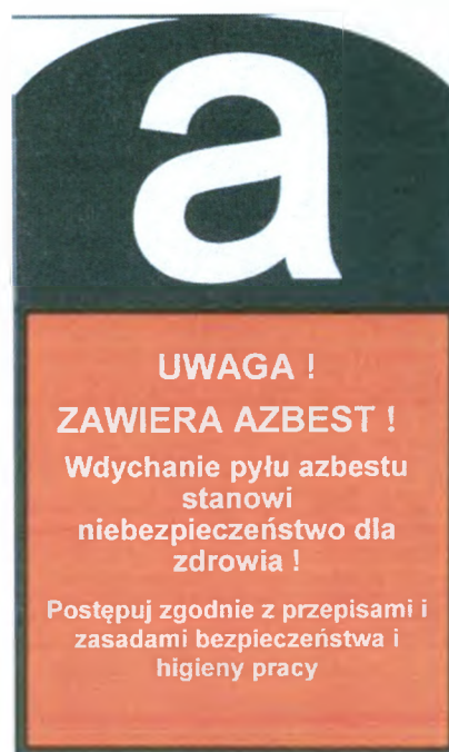
Rys.2. Wzór etykiety do oznakowania wyrobów i odpadów zawierających azbest, zgodnie z załącznikiem do Rozporządzenia Ministra Gospodarki, Pracy i Polityki Społecznej z dnia 2 kwietnia 2004 r. w sprawie sposobów i warunków bezpiecznego użytkowania i usuwania wyrobów zawierających azbest.
